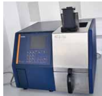
Fot. 4. Analizator bliskiej podczerwieni do analizy wilgotności i innych parametrów ziarna Infra-tec 1241 Grain Analyzer (Foss)
