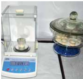
Fot. 1. Referencyjny pomiar wilgotności ziarna metodą suszarkową
